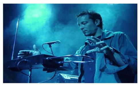
De taille bien moindre que le Thelharmonium, il s'agit d'une machine monophonique surplombée de deux antennes. Le Théremin emploie deux oscillateurs délivrant de très hautes fréquences (l'une fixe, l'autre variable) dans le domaine de l'inaudible. L'interférence
